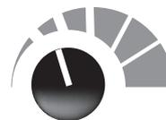
Dans le sens des aiguilles d'une montre : vous augmentez la distance entre le fil et la zone de fonctionnement du collier récepteur et inversement vous diminuez la distance.
